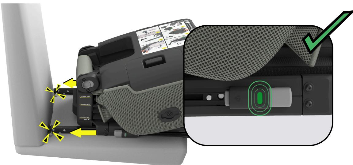
Postavite autosjedalicu na sjedalo vozila i pričvrstite ISOFIX priključke (H) na ISOFIX priključne točke u vozilu. Provjerite jesu li indikatori (I) na obje ISOFIX priključka postali zeleni.
