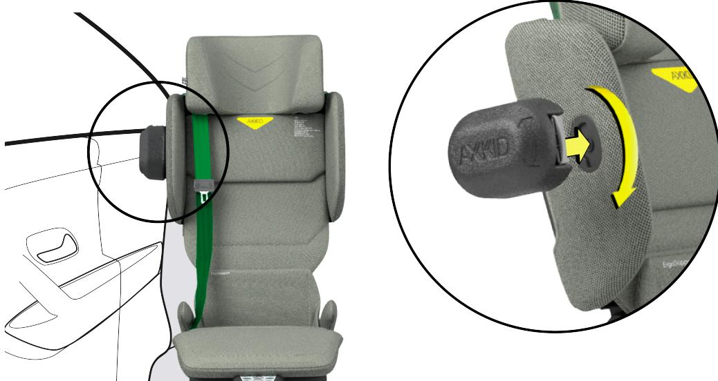
Postavite ASIP jastučić (N) na bočnu stranu autosjedalice najbliže vratima vozila. Poravnajte ASIP jastučić s držačem za ASIP te ga pričvrstite pritiskom i zakretanjem na mjesto.
