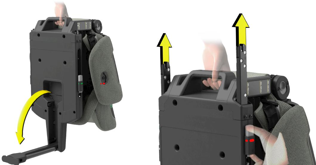
Držite ručku za nošenje (U) i izvadite potpornu nožicu (Y) iz njezinog spremišta (X).
