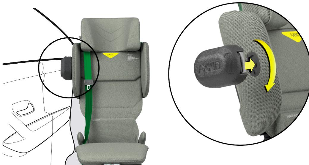
Installare il cuscinetto ASIP (N) sul lato del seggiolino più vicino alla portiera del veicolo. Allineare il supporto del cuscinetto ASIP con il supporto ASIP e fissarlo spingendolo e ruotandolo in posizione.
