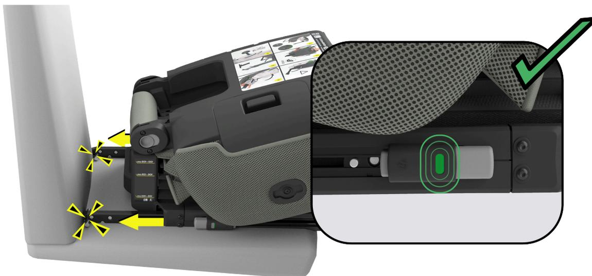
Posizionare il seggiolino per auto sul sedile del veicolo e fissare i connettori ISOFIX (H) ai punti di fissaggio ISOFIX del veicolo. Verificare che gli indicatori (I) su entrambi i connettori ISOFIX siano diventati verdi.
